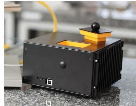
Kompaktní 6-kanálový senzor založený na nové metodě spektroskopie povrchových plasmonů (SPRCD).
