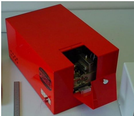
Mobilní kanálový senzor založený na spektroskopii povrchových plasmonů a multiplexování vlnových délek.
