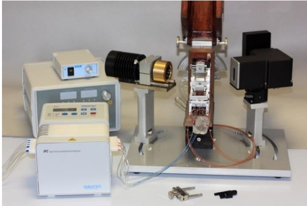
Laboratorní 6-kanálový senzor založený na spektroskopii povrchových plasmonů.
